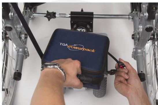
**Fig. 7. Mise en place et connexion de la batterie**
