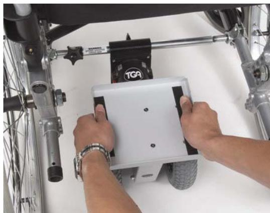
**Fig. 4 Fixation de la barre transversale**
